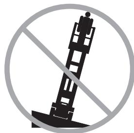
Não dependa do alarme de inclinação como um indicador de nível. O alarme de inclinação soará no chassi somente quando a máquina estiver em declive acentuado.
