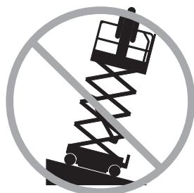
Não eleve a plataforma a não ser que a máquina esteja em uma superfície firme e nivelada.
