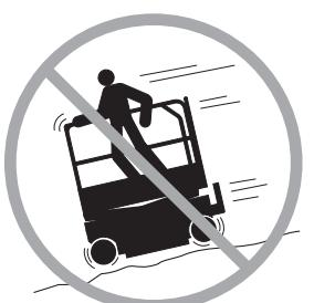
Limite a velocidade do percurso de acordo com as condições da superfície, de congestionamento, inclinação, localização de pessoas e quaisquer outros fatores que possam causar colisão.
