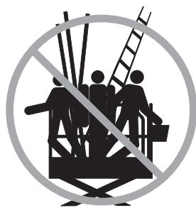
Não coloque escadas ou andaimes na plataforma ou apoiados em qualquer parte da máquina.
