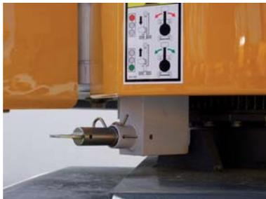
**Fixação da torre (Referir-se à configuração da máquina)**
